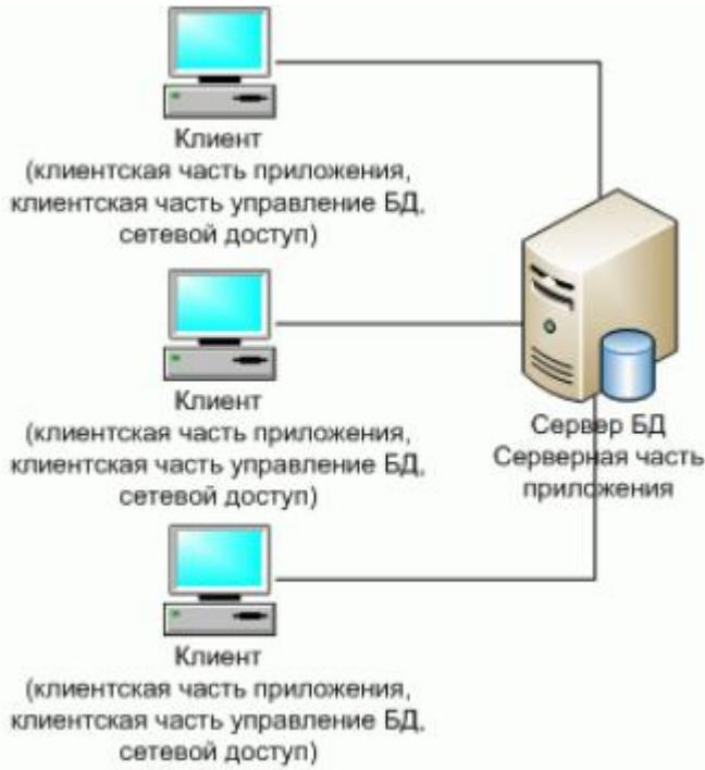
*Рис. 2. Классическое представление архитектуры "клиент-сервер"*
